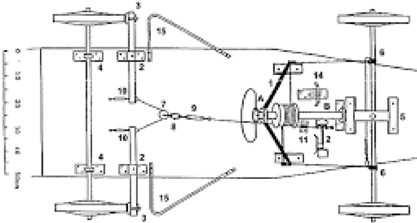
**Der Achsabstand muss so angeordnet sein, dass  $\frac{2}{3}$  vom Gewicht des Fahrers auf der Hinterachse lastet**
